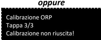
→ Effettuare nuovamente la navigazione con le istruzioni di cui sopra, anche più volte se necessario. Se la calibrazione ancora non riesce, sostituire la sonda, quindi effettuare nuovamente una calibrazione.
